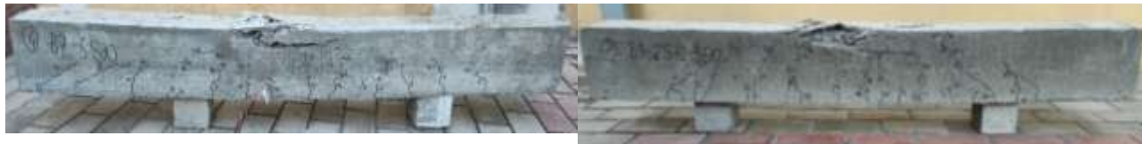
5-rasm. To'sinlarni eksperimental sinovdan keyingi ko'rinishi
