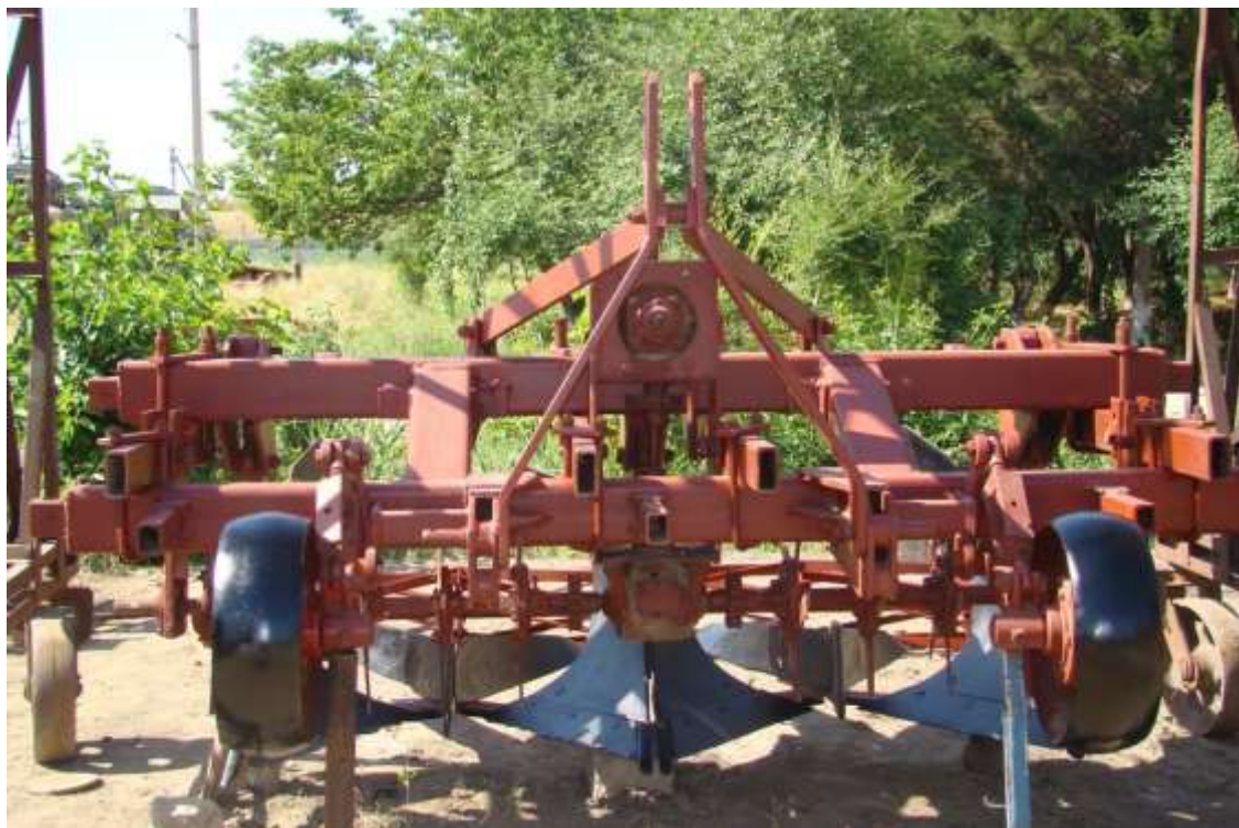
2-расм. Фаол иш органли комбинациялашган фронтал плугнинг тажрибавий нусхаси (олд томонидан кўриниши)
