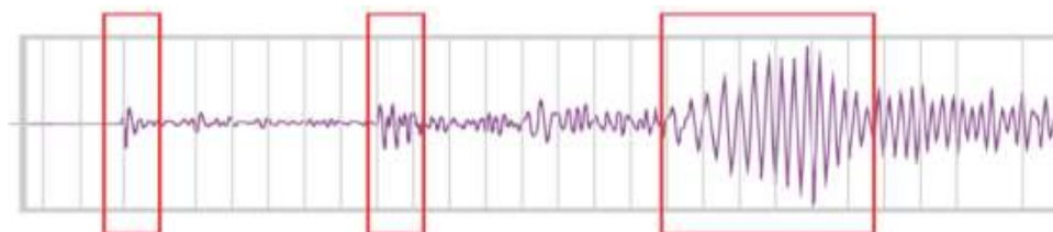
P to'liqlarining S to'liqlarining Sirt to'liqlarining boshlanishi
