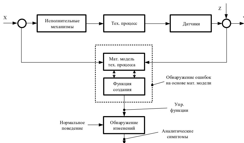
Рис.1. Мониторинг на основе моделей процесса: x – соответствует управляемым переменным, y – соответствует выходным переменным всего процесса, z – представляет аддитивные переменные возмущения.
