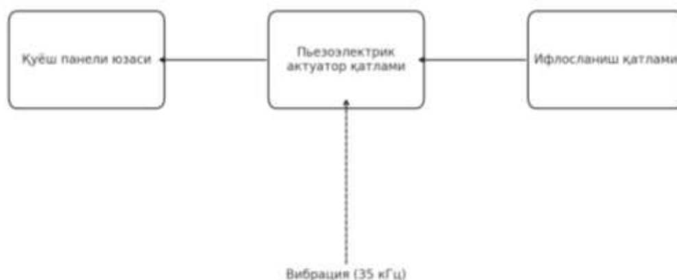
1-rasm. Pyezoelektrik tozalash tizimining ishlash prinsipi
